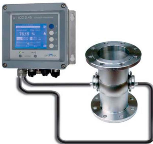
A medição sem contacto é composta por dois sensores planos montados de um tubo, um sensor de temperatura para compensar as flutuações de temperatura e a unidade de avaliação.
